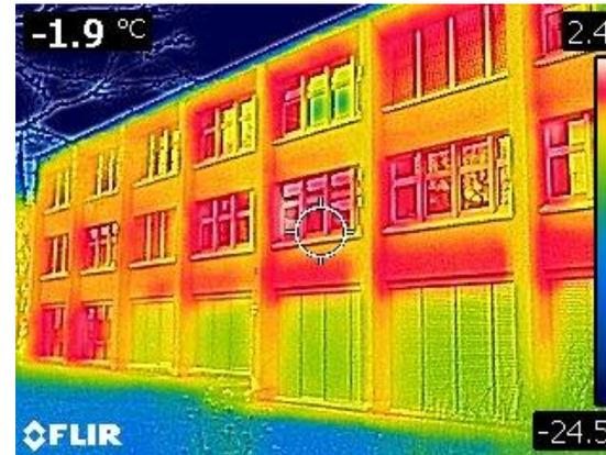
Mit einer **Wärmebildkamera** kann man Wärmestrahlung sichtbar machen. Rot eingefärbt sind hier Bereiche, wo viel Wärme über die Hausfassade nach draussen abgegeben wird.
