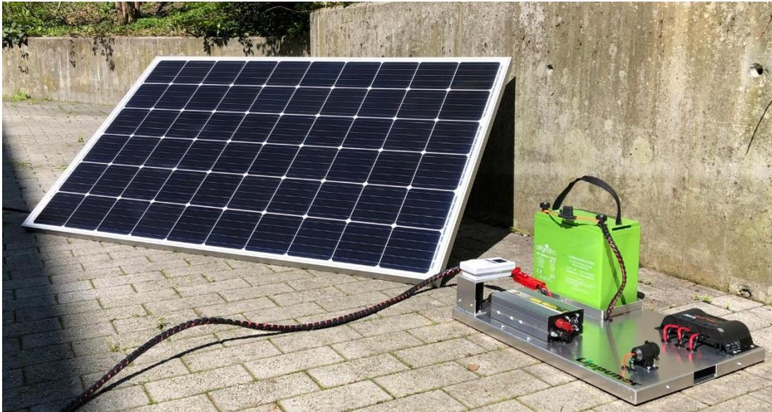
Bild 1: Photovoltaikmodul mit Anschlussplatte
