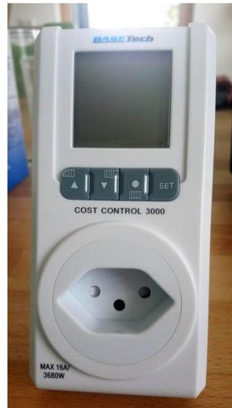
Das Energiemessgerät ist fix auf der Anschlussplatte montiert. Endgeräte werden grundsätzlich hier angeschlossen.
