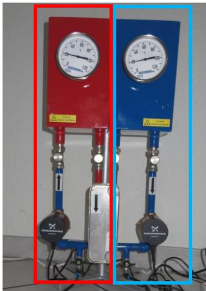
Im Modell entspricht der rote Wasserbehälter dem Fernwärmeeinlauf aus dem Fernwärmenetz, der blaue dem Warmwasservorratsbehälter im Haus.
