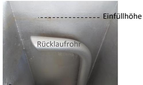
Abb. 8: Einfüllhöhe Wasser
