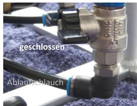
Abb. 7: Detail Entleerungshähne
