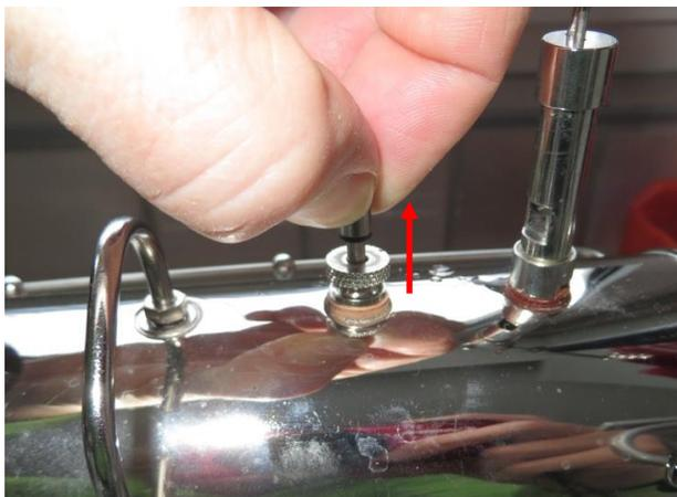
Abb. 11 Kontrolle Federsicherheitsventil
