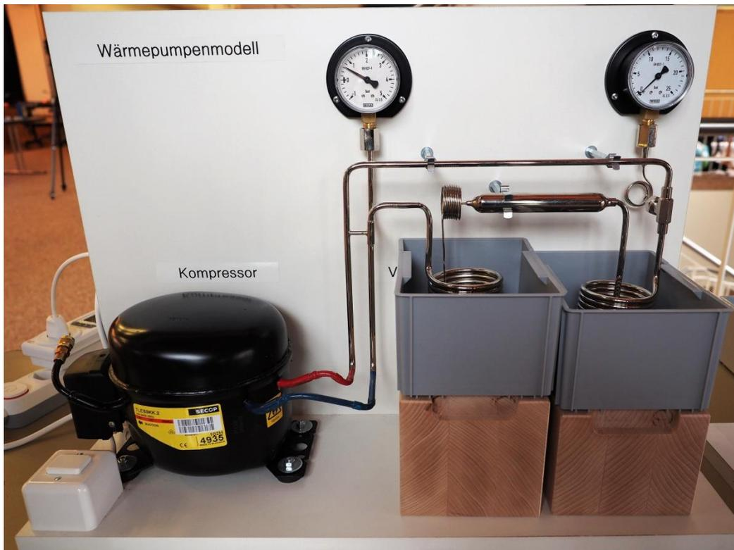
Abb. 4: Aufgebaute Wärmepumpe
